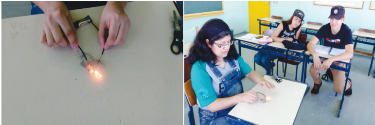
Figura 4: Esponja de aço sendo percorrida por elétrons
